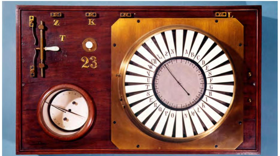
Der elektromagnetische Telegraf begann sich auch in anderen Ländern durchzusetzen. In Preußen entwickelte Werner von Siemens einen Zeigertelegraphen, basierend auf dem von Wheatstone und Cooke konzipierten Nadeltelegraphen. Nach Abschluss des Vertrages mit der Berliner Werkstätte der Präzisionsmechanik Böttcher & Halske konnte der erste Siemens-Zeigertelegraf Ende Juni 1847 fertiggestellt und auf der Bahnstrecke zwischen Berlin und Potsdam erfolgreich getestet werden.
