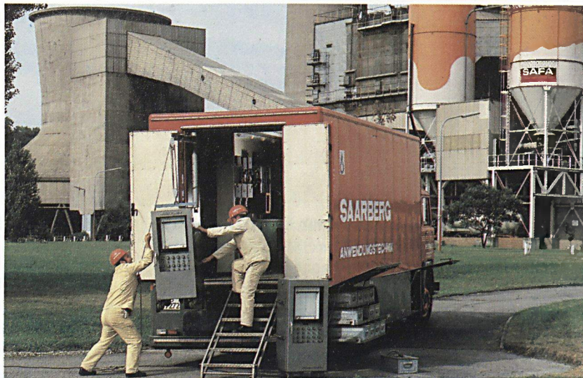
Ein Meßwagen mit Einrichtungen zur Überwachung von Feuerungsanlagen
