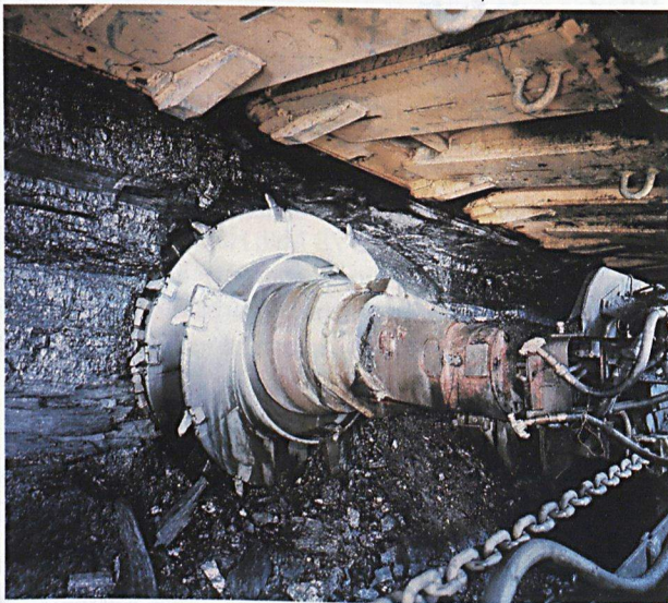
Walzenschrämlader und Schildausbau in einem mächtigen Flöz
