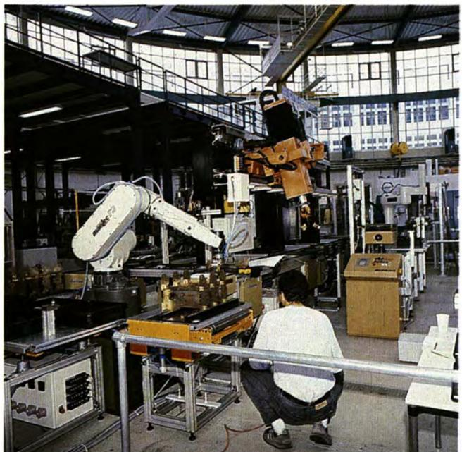
Rüstflexible Montagezelle zur automatischen Kleinteilmontage
